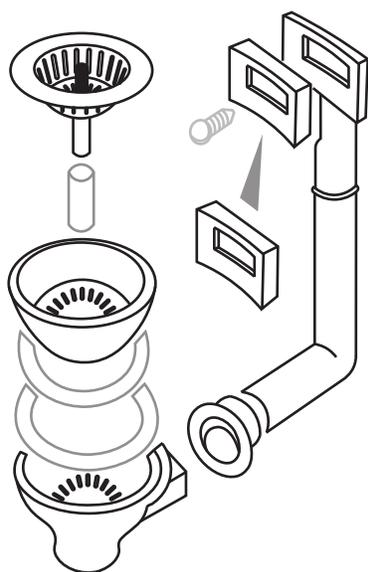
PREPARAR EL FREGADERO CON EL TUBO DE DESAGÜE INSTALADO
