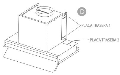
Afloje los tornillos de fijación de la placa posterior 1 y de la placa posterior 2 para que pueda moverse libremente, y bloquee los tornillos de la placa posterior 1 y de la placa posterior 2 hasta que la campana extractora quede ajustada a la posición correcta del mueble.
