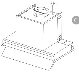
Instale primero las válvulas antirretornos en el adaptador de salida de aire. A continuación, fije el conducto en el adaptador de salida de aire con 2 tornillos (ST2.9\*8). Nota: El conducto no está incluido en el paquete.
