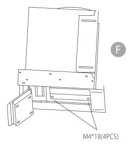
Monte 4 tornillos M4\*18 en los dos lados interiores de la campana extractora para fijarla en el mueble.
