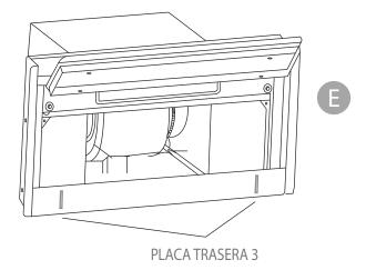
Afloje los tornillos de fijación de la placa posterior 3 para que pueda moverse libremente y, a continuación, bloquee los tornillos hasta que a campana extractora quede ajustada a la posición correcta del mueble.
